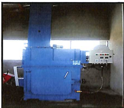
Incinérateur pour les structures sanitaires
